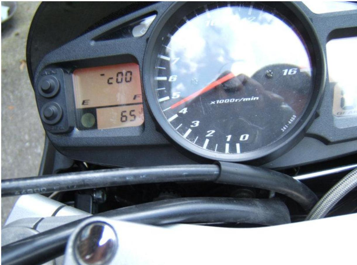
Wie man sieht ist der „ – „ jetzt in der oberen Stellung. Aber erst bei 4500 u/min. So sollte er aber schon im Standgas sein! Und unabhängig von der Drehzahl nicht mehr wandern!
