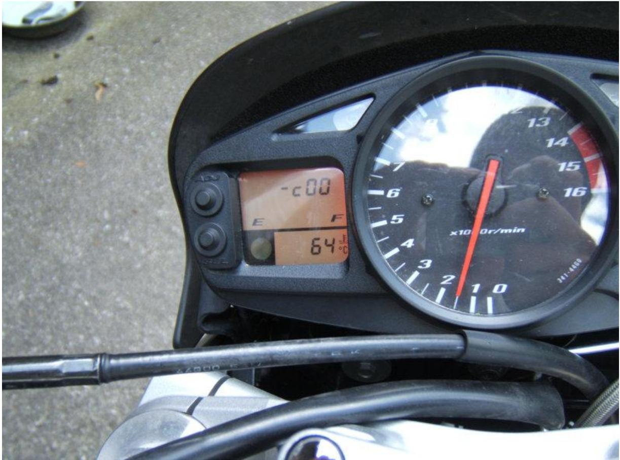
Das ist die Anzeige die der Diagnosestecker erzeugen sollte! Auf dem Bild ist das „ - „ in der Mitte bei Standgas. Es sollte aber in der oberen Stellung sein. Siehe Bild 3
